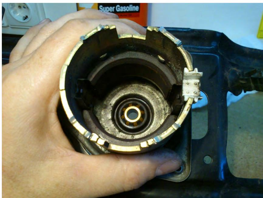
Насмотревшись, протираю всё от пыли, смазываю вал и втулки моторным маслом и всё собираю назад. Нужно следить за тем, чтобы масло не попало на щётки и коллектор, я как-то такое по глупости испытал на двигателе стиральной машины-автомат типа «Сименс», запаху было))). Но если такое случится — нестрашно, достаточно всё хорошенько протереть. Запоминать как стояла задняя крышка не нужно, её иначе не поставишь.
