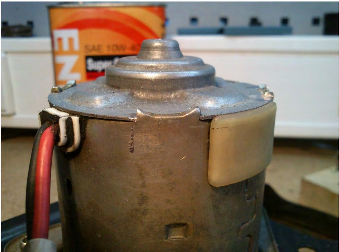
Развальцовку стачивал на задней крышке. А вот и она с сидящим в ней подшипником — бронзовой (или латунной) втулкой. Её нужно смазать жидкой смазкой, можно моторным маслом. Если по научному, то её (втулку) вроде нужно выдерживать какое-то время в разогретом масле (где-то такое читал), ну мы же «гусские»...
