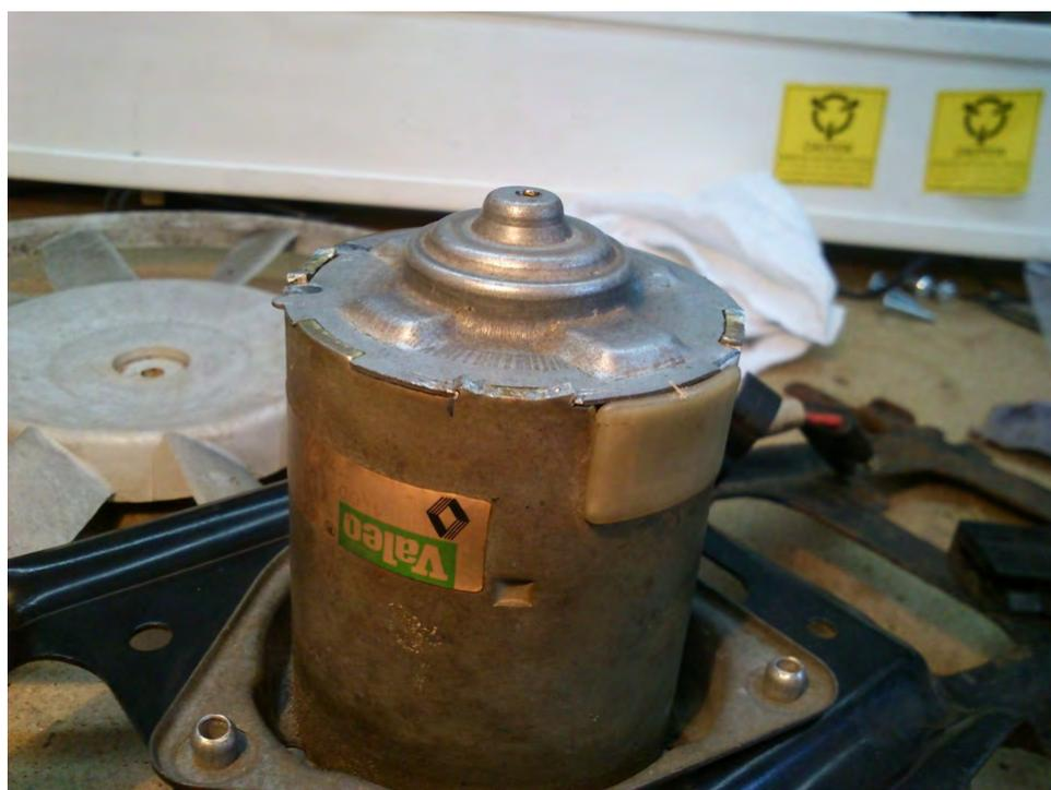
Совсем забыл. Так как стопор, крепящий крыльчатку сгнил, пришлось раскрутить мотор блоком питания и пропиливать обычной ножовкой вот такую борозду на валу под новый самодельный стопор (борозды изначально не было). Стопор выгнул из обычной сварной проволоки (можно из толстой пружины), закинул туда солидола. Ещё можно было бы закрыть это всё каким-нибудь колпачком, но ничего подходящего не нашлось.
