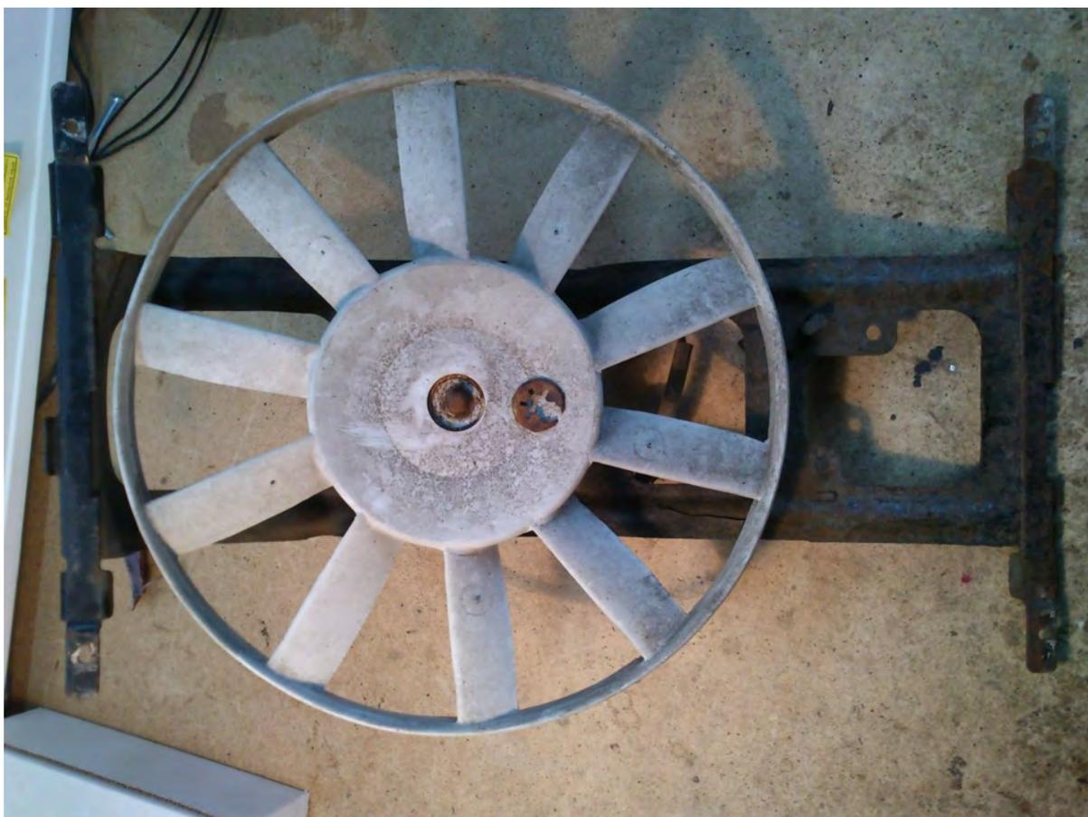
Снаружи на валу сидит пружинящая шайба, которая не даёт крыльчатке слететь с вала и которая у меня почти сгнила. Шайба-стопор выполнена так, что надеть её легко, а вот снять уже намного труднее. У меня получилось легко, помогла коррозия, и я её просто сломал. Потом ещё пришлось на валу поработать бормашинкой, т.к. нарост коррозии не давал снять крыльчатку с вала.
