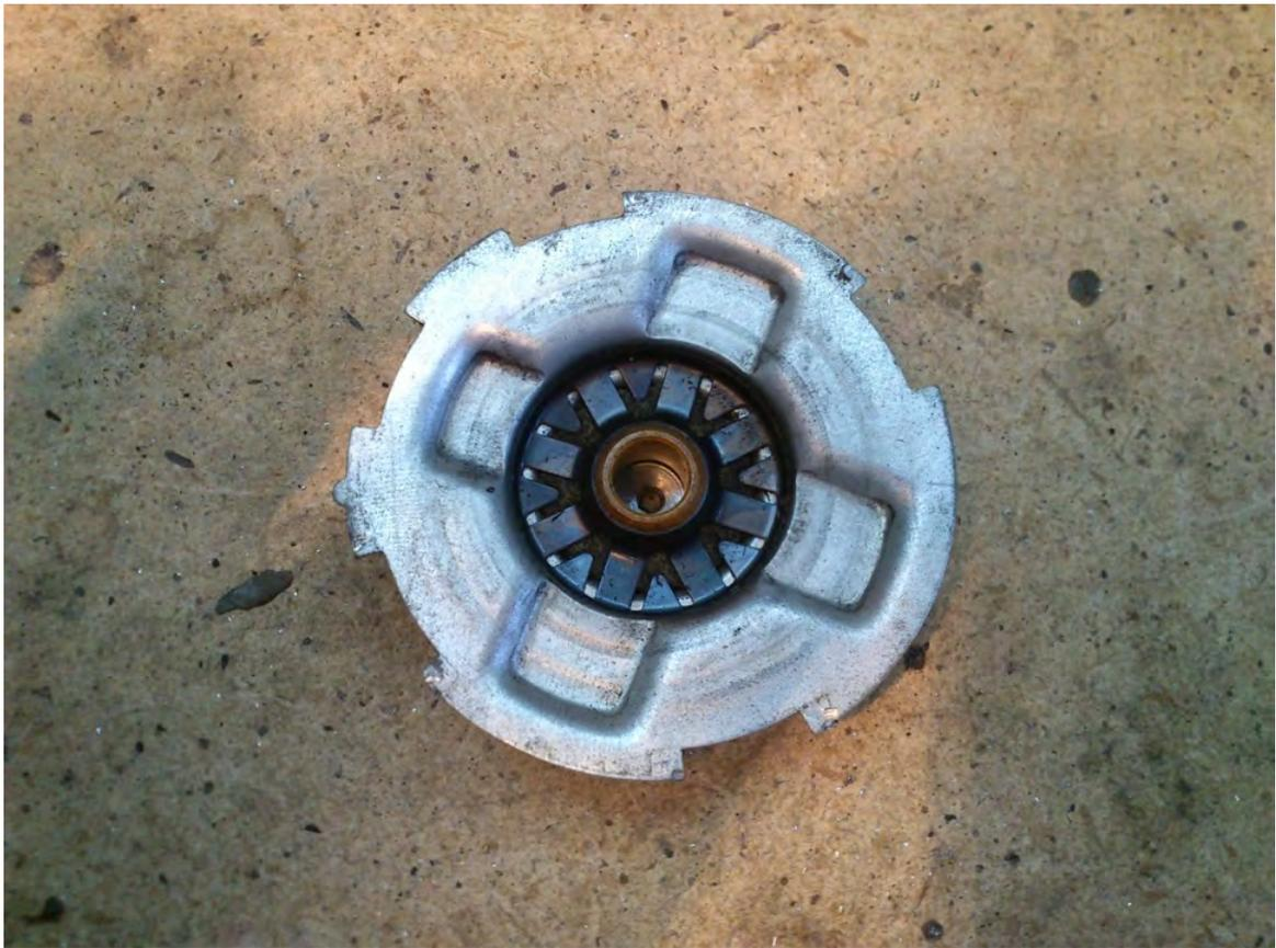
А вот и пластина со щётками. Просто снимается вверх, при этом придерживаем пластмассовые оправки (выступают наружу по бокам), т.к. на них несильно, но всё же давят пружинки, которые прижимают щётки (пружинки могут улететь, щётки припаяны). Щётки из какого-то металла (или сплава), состояние щёток отличное, наверное рассчитаны на весь автомобильный ресурс машинки.
