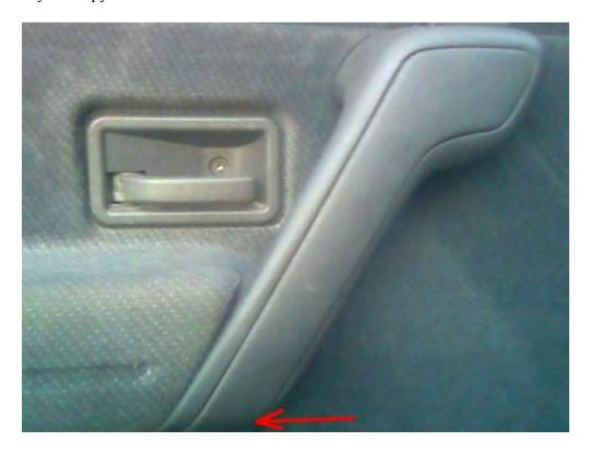
Затем откручиваем винтик с ручки открывания двери и тянем ее на себя поворачивая против часовой стрелки (там надо ее снять с изогнутой спицы)
