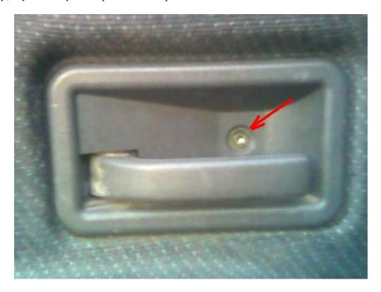
После снятия заглушки и ручки открывания двери, у вас получается такая картина, в ручке 2 винта (долбаные звездочки) Откручиваете их и снимаете ручку
