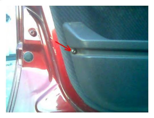
И так теперь можно снять обшивку двери , начинать лучше снизу ,очень плавно тянем на себя, будет щелчок - это отщелкиваются пистоны вот вам фото обшивки с другой стороны и заодно и двери
