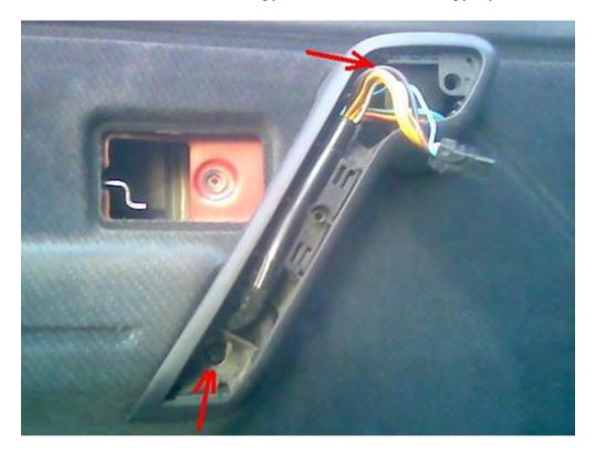
Дальше отвинчиваем карман , там два винтика по краям и подимаете его вверх ( снять с пазов )
