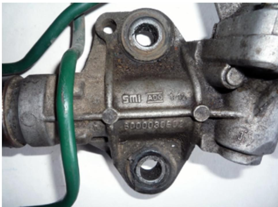
Проще всего демонтировать рейку со снятого подрамника. Но ходят слухи об умельцах, которые могут открутить и достать рейку лёжа на земле под машиной...
