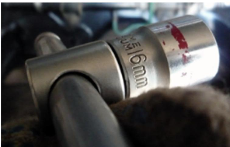
Отворачиваем им четыре болта крепления рейки к подmotorной раме и откладываем раму в сторонку. Рейка снята!
