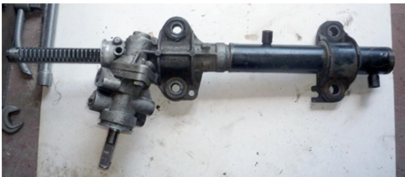
Выкручиваем два болта крепления червячного механизма и снимаем распределитель
